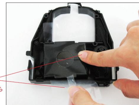
6. 本体カセットの上カバーにあるピンをカセットの差し込み穴に合わせ、本体カセットを閉じます。その際、6箇所のツメがしっかりとかかっているか確認し、ロック部分を上にスライドしてください。
