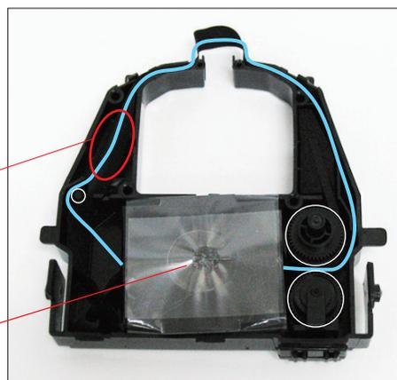
5. 交換用リボン (つめかえ用サブカセットリボン) のフィルム帯の接着部をはがし、黒いケースが持ち上がらないように指で軽く押さえながらフィルム帯をゆっくりと引き抜いてください。その後で、黒いケースも真上に持ち上げて、抜き取ります。
