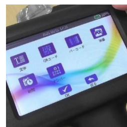
タッチパネルでレイアウトを編集し、文字、QR、バーコード、画像、時間、ナンバリングなど印字できます
